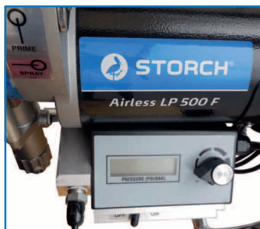
LCD display ulehčuje nastavení tlaku
